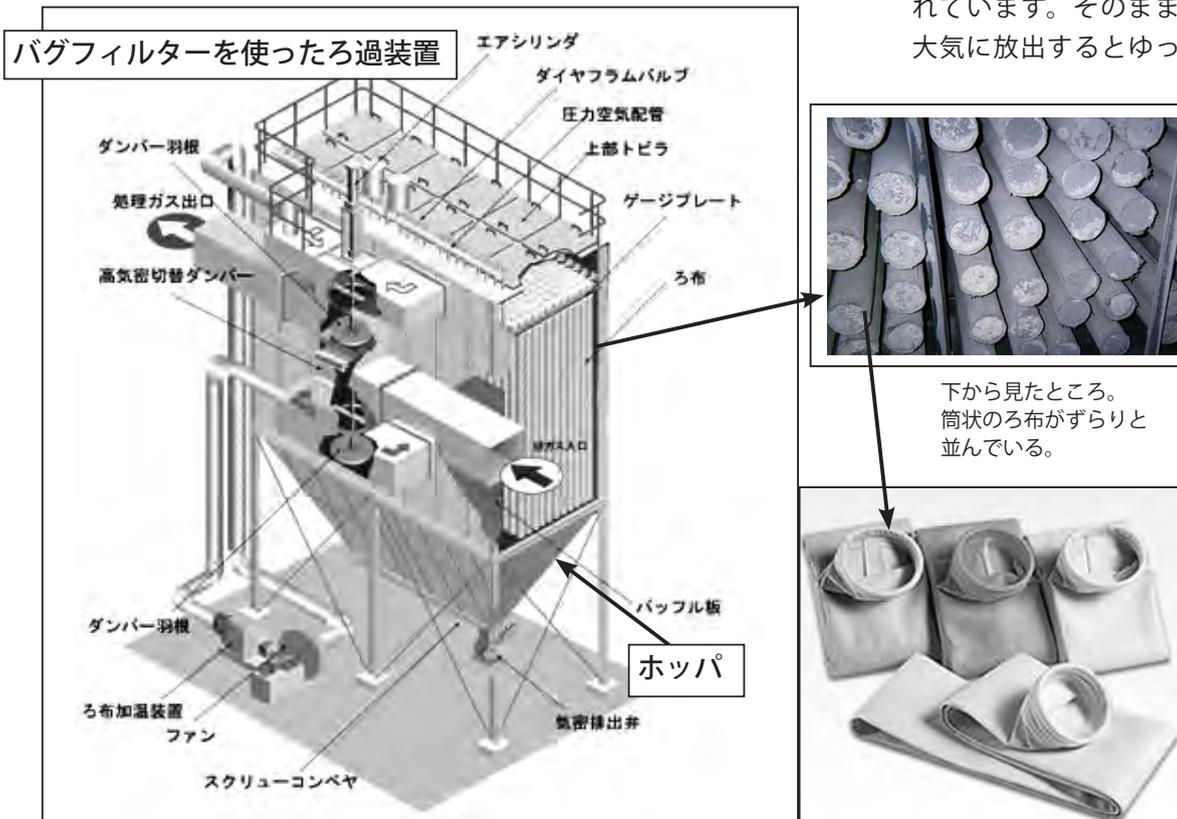
くり冷やされて、ダイオキシンや窒素酸化物（NOX）等ができてしまうので、それを防ぐために排ガスを急速に 150℃～200℃まで冷却して、蒸発していた成分を煤塵（飛灰）として析出させています。セシウムも粒状化して飛灰となります。それらの飛灰を集塵機で取り除きます。放射性物質は主灰にも含まれていますがほとんどが飛灰に含まれています。この集塵機の多くに使われているのが筒状のろ布、バグフィルターです。（左ページ図参照）
