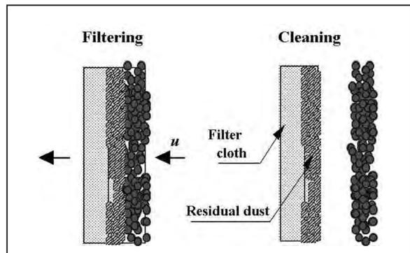
果が出ています。これが一般廃棄物焼却処理施設や下水処理場の活性汚泥焼却施設で用いられている標準的なバグフィルターの性能です。
